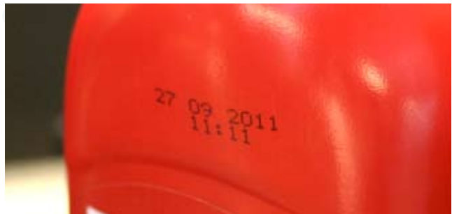
Datummärkning på Felix ketchup med Hitachi bläckstråleskrivare
