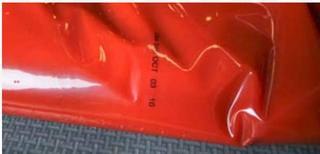
Datummärkning på påsar för storhushåll med Allen 53LTi
