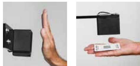
Kraftsensorer gör att en installation med CE-certifiering kan göras utan skydd. Sensorerna känner även av motstånd och används för att känna av att etiketten appliceras.
