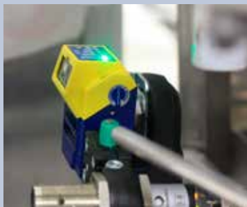
Innan refillpåsen fylls kontrolleras streckkoden av med en kamera.
