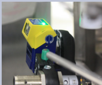
Innan refillpåsen fylls kontrolleras streckkoden av med en kamera.
