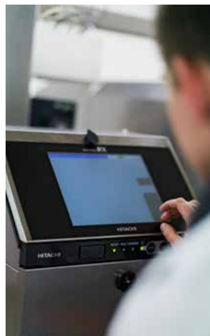
RX2-serien erbjuder intuitiv och enkel programmering på en 10,4" TFT-LCD-pekskärm. Alla skrivarfunktioner visas som ikoner för enkel navigering.
